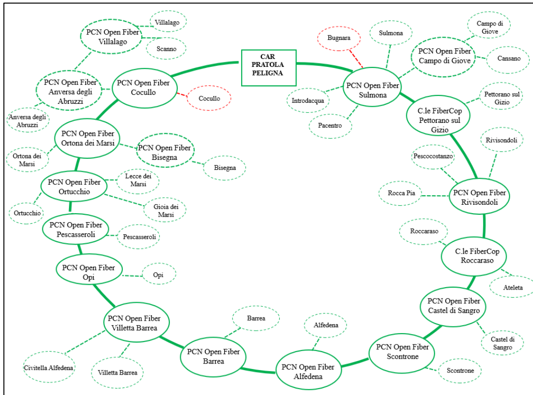
Figura 12 - Schema logico Anello 11 Pratola Peligna
