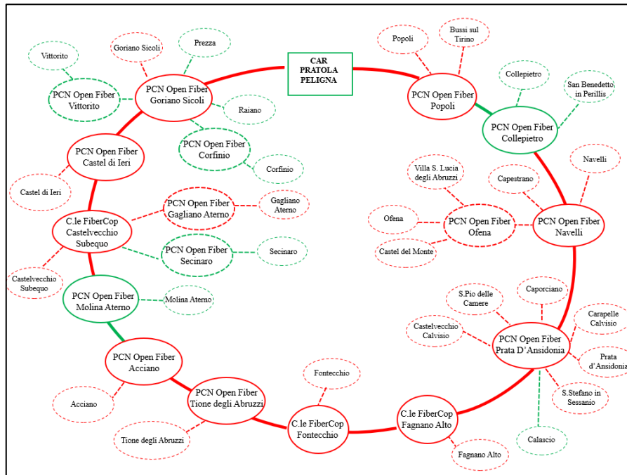
Figura 16 - Schema logico Anello 12 Pratola Peligna
